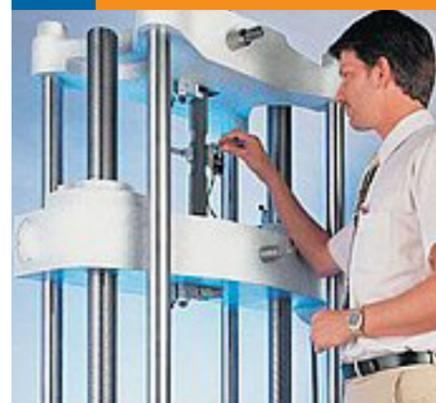
Tinius Olsen US est un fabricant américain d’une série de bancs d’essais hydrauliques et des bancs de traction et de compression typiquement utilisés pour mesurer à des forces supérieures (de 60 kN à 3000 kN). Des modèles qui sont uniquement utilisés pour des tests de compression sont également disponibles.
