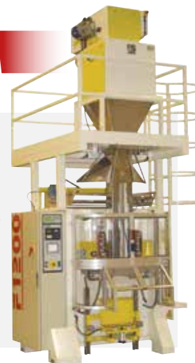
Ensacheuses verticales FFS-V à partir d'une bobine de film plastique à plat
