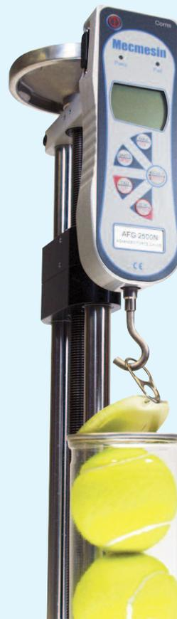
Test de la force d'ouverture d'opercule
