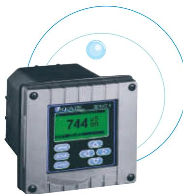
Le PRO est un appareil économique très compact, auto-alimenté basse tension par sa boucle 4-20 mA (transmetteur 2 fils). Il existe lui aussi en déclinaisons multiples (pH, rédox, conductivité, oxygène).
