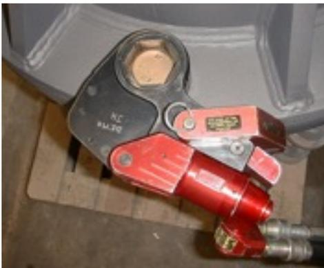
La gamme de clés **XLCT** est une gamme de clés dynamométriques hydrauliques à cartouches d'entraînement interchangeables conçues par **HYTORC USA**. Cette gamme de clés à faible encombrement peut recevoir une multitude de cartouches à oeil hexagonal ou 12 pans. La réaction des clés de type XLCT s'effectue en ligne .Au même titre que la gamme de clés MXT ,la gamme XLCT est un classic des produits HYTORC, reconnue pour sa robustesse.
