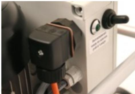
Ce groupe moto pompe est le plus petit fabriqué par HYTORC; il convient parfaitement pour l'utilisation des clés de type AVANTI P7, 1 et 3 , de type MXT P7, 1 et 3 , de type XLCT 2 et de type STEALTH 2 .Son faible encombrement en fait un atout certain pour l'utilisation en chantier lors de la vérification de serrage de boulonneries dans les endroits confinés ou d'accès difficile.
