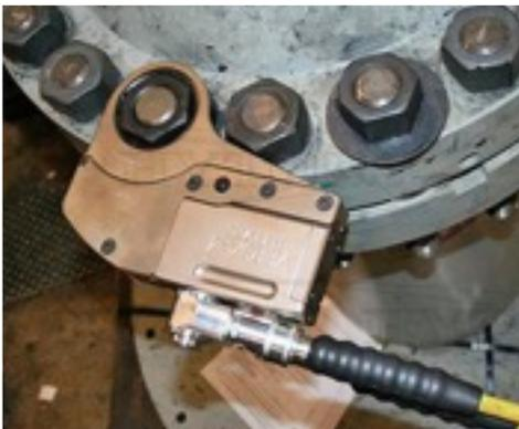
La gamme de clés **VERSA** est une gamme de clés dynamométriques hydrauliques conçues par **HYTORC USA**. Cette série a été conçue pour les opérations de maintenances occasionnelles. Le système d'entraînement de cette série **VERSA** est différent des autres gammes de clés **HYTORC**. Ces clés n'intègrent pas le système d'entraînement anti-retour. Toutefois ces clés conviennent parfaitement aux clients souhaitant investir dans un équipement d'entrée de gamme.
