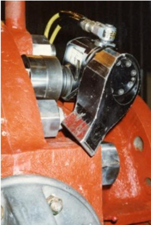
La clé dynamométrique hydraulique HY 25 XLT , permet les desserrages de boulonneries de tailles importantes . Cette clé à été développée il y a de nombreuses années et figure toujours au catalogue HYTORC. La clé HY 25 XLT est souvent utilisée pour le démontage de boulonneries corrodées ou oxydées, que se soit en milieu marin ou sur les plates- formes pétrochimiques. Le système anti retour breveté par HYTORC au début des années 80 avec les séries SL est repris sur cette clé.
