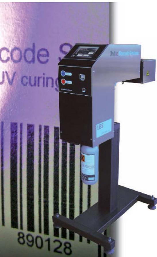
Les systèmes d'impression jet d'encre, APLINK UV ont été développés pour identifier n'importe quel type de produit à surface poreuse ou non poreuse. Conçue pour l'impression haute définition de textes, d'images, de logos et de codes barres, la gamme APLINK UV marque sur tout type de support (surface cartonnée brillante ou ondulée, plastique, céramique, carte électronique, etc ...).
