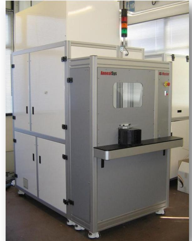
**Gamme de mesure étendue par pyromètre : 150°C to 1400°C**
