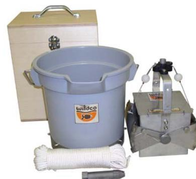
Exemple de kit bennes à sédiments Ekman, avec ligne et seau filtre 500µm, caisse de transport.
