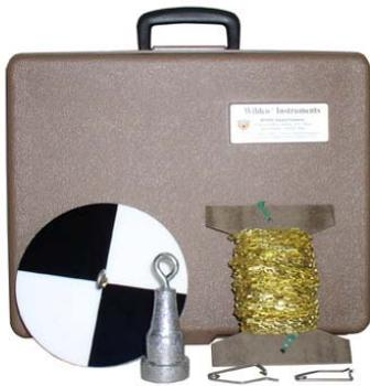
Kit disque de Secchi, plomb de sondage, eaux douces et marines
