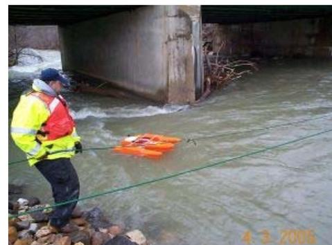
Jaugeage par relevé de profil du lit, de profil du courant et avec calcul du débit en temps réel ADCP
