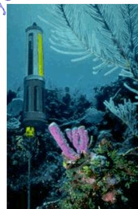
Surveillance in situ avec enregistrement autonome
