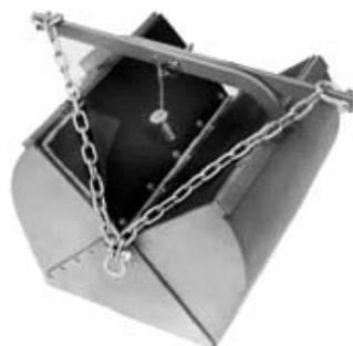
Benne à sédiments VanVeen. Autres modèles Shipeck, petite & grande Ponar, etc.
