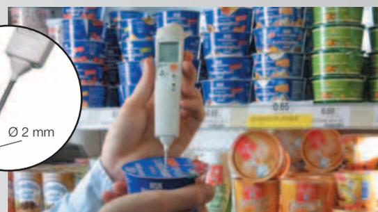
Test rapide de température (screening-test) et mesure de température à cœur
