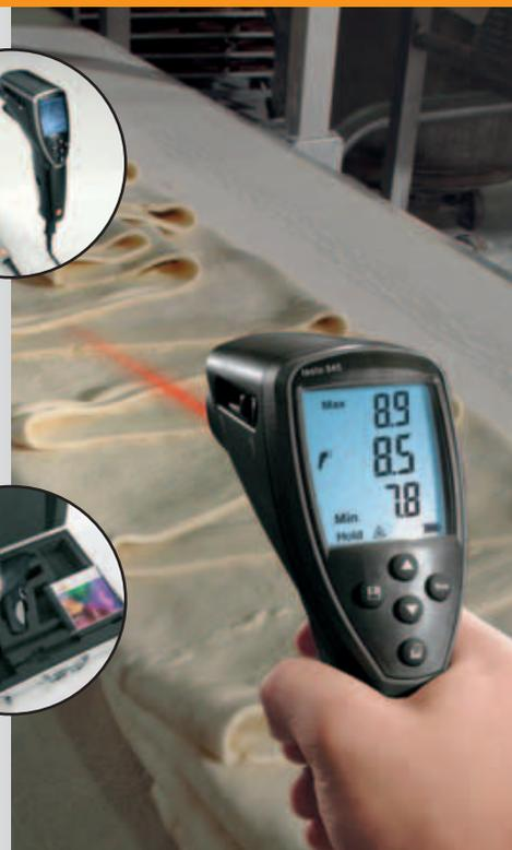
Contrôle exact de la température en production
