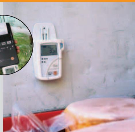
L'enregistrement des variations de la température, par exemple pour le stockage ou le transport de la viande dans le cadre de la protection qualité
