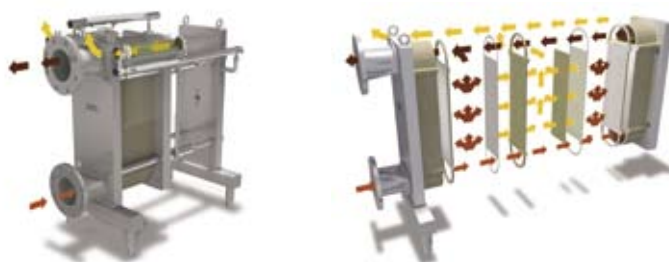
Schéma d'écoulement dans un module à plateau. En rouge, le fluide d'alimentation/le rétentat. En jaune, le perméat.
