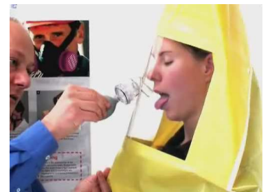
Réalisation d'un test de sensibilité préalable au fit test Bitrex
