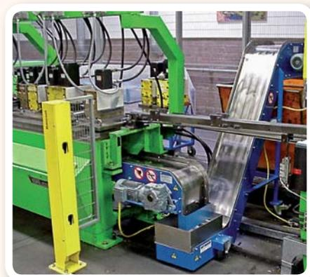
Combinaison de convoyeurs plat & col de cygne pour l'évacuation de particules de poinçonnage.
