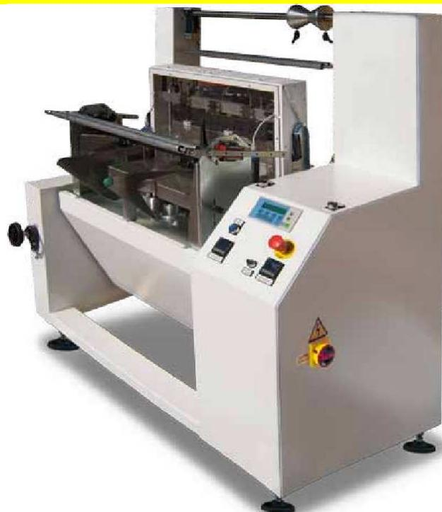
L'emballage est réalisé grâce à deux couples de roues motrices , l'un de scellage , l'autre d'entraînement du film et une barre de soudure horizontale mécanique .
