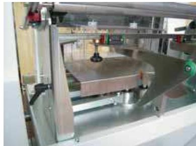
Le sachet est ajustable en longueur soit pré-programmé soit déterminé par la longueur du produit et détecté par cellule
