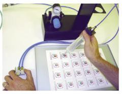
Mise en place de la résine sur les étiquettes
