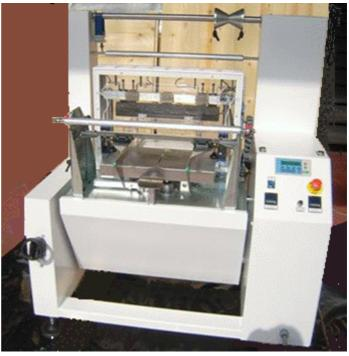
L'emballage est réalisé grâce à un deux couples de roues motrices , l'une de scellage , l'autre motrice du film et une barre de soudure horizontale mécanique .
