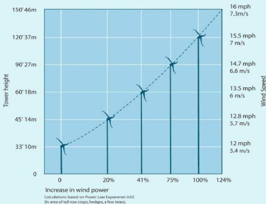
Car la vitesse du vent (donc l'énergie électrique produite par les éoliennes) augmente avec la hauteur. Pour savoir cette vitesse à cette hauteur, il faut nous contacter.
