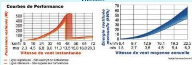
Le contrôleur tient compte de la variation de puissance du vent en optimisant le rendement de l'alternateur. Il optimise cette production en temps réel en chaque point de la courbe de puissance cubique pour fournir efficacement l'énergie à la batterie. Le contrôleur intègre un capteur de couple sur l'axe de l'alternateur lui permettant de commander réellement la vitesse de rotation de l'hélice. On élimine de ce fait le bruit de ronflement généralement trouvé avec l'ancien modèle Air 403 et 303 .
