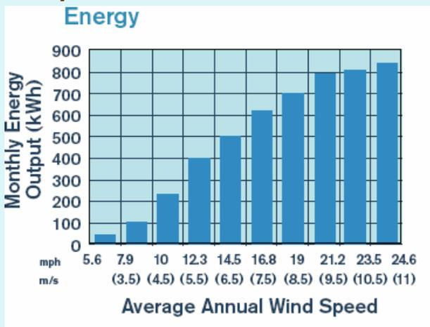
Une éolienne comme la SkyStream peut assurer en moyenne la même production qu'une éolienne de 3 kW sinon plus car c'est une éolienne qui maintient sa puissance maximale pour des vitesses supérieures à sa vitesse nominale.
