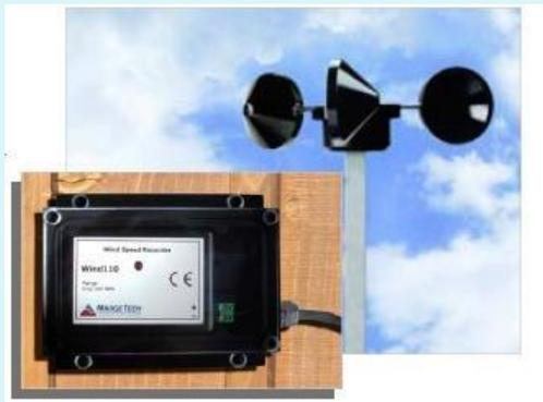
Pour vérifier par vous même le potentiel éolien de votre site, utilisez notre Wind110 qui est un système complet de mesure et d'enregistrement de la vitesse du vent sur de longues périodes de temps. L'anémomètre peut être installé sur votre toit pour recueillir des mesures instantanées et les transmettre à votre ordinateur pour sauvegarde, analyse...
