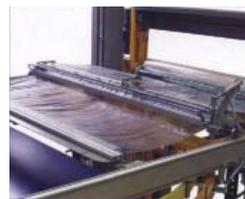
**Dispositif de dépose de coiffe**
