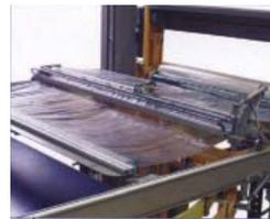
**Dispositif de dépose de coiffe**
