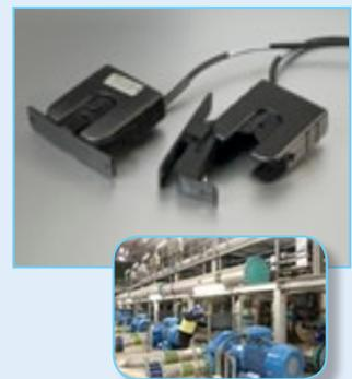
La pince ampérométrique détecte le démarrage d'une pompe et permet ainsi la surveillance et la fréquence de fonctionnement des pompes. Le volume d'eau pompée est alors calculé à partir du temps de fonctionnement de la pompe.
