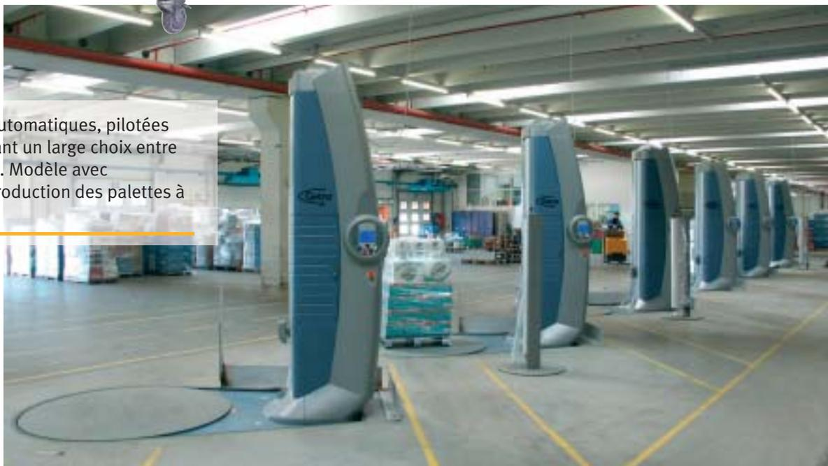
Cette banderoleuse à bras tournant est équipée d'un système d'accroche automatique du film au bas de la palette, afin de parfaitement solidariser la charge avec la palette. Plus aucune intervention humaine n'est nécessaire pour banderoler vos palettes.
