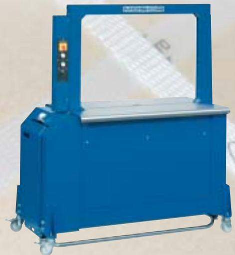
Cercluse automatique assurant 50 cerclages/minute – Arche de 500 x 400 mm à 2000 x 1000 mm, en feillard de 5 à 12 mm – Intégration de presse simple et double pneumatique.
