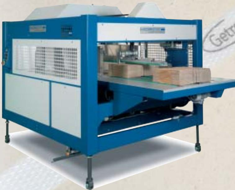
Cercluse ultra compacte intégrant un taquage sur les 5 faces (sens des cannelures) – Mémorisation automatique du format des paquets lors du premier cycle (auto-calibration) – Alignement latéral motorisé permettant un positionnement du cerclage à l'endroit désiré sans translation de la machine.
