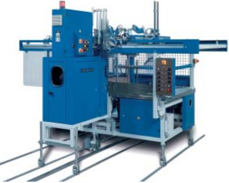
Combiné de taquage/cerclage des caisses 4 et 6 coins collés – Installation derrière plieuse/colleuse.
