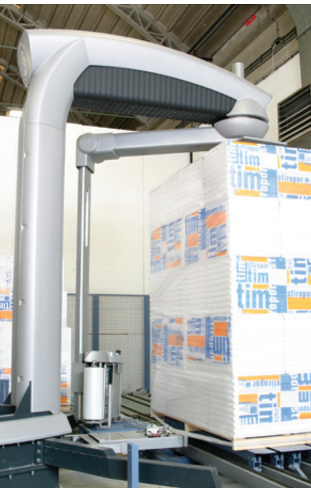
Banderoleuse automatique avec bras tournant. Cette machine est équipée d'une unité attachant automatiquement le film à la palette à banderoler.
