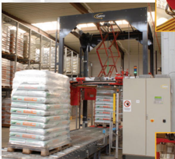
Une banderoleuse full automatique, intégrée dans une ligne pour le banderolage en haute cadence : jusqu'à 120 palettes par heure.
