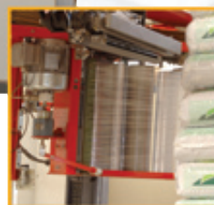
Une banderoleuse full automatique, intégrée dans une ligne pour le banderolage en haute cadence : jusqu'à 120 palettes par heure.
