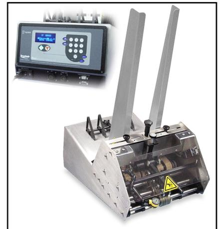
*Nos solutions d'alimentation automatique utilisant la technologie de Friction Différentielle sont conçues pour être la solution flexible et innovante à vos problèmes d'automatisation et d'alimentation. Les modèles « ST 1250 Pro » permettent ainsi un retour sur investissement rapide grâce à une grande simplicité de mise en service et d'utilisation, et un rapport coût / efficacité nettement amélioré de vos travaux d'alimentation.*
