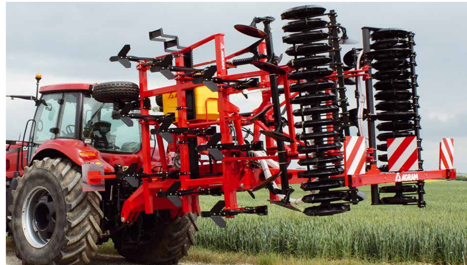
Rasettes de série sur rouleau V-ring.
