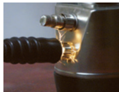
Capteur POWERCELL PDX testé en laboratoire lors de la simulation d'un foudroiement.
