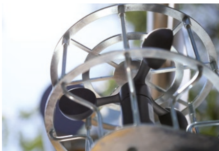
Anémomètre de contrôle et avertissement d'atteinte de la vitesse de vent maximale admissible (45 km/h).
