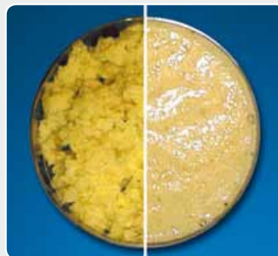
Comparaison du degré de broyage de pommes de terre crues, homogénéisées avec un robot ménager (à gauche) et avec le GRINDOMIX GM 200 (à droite).
