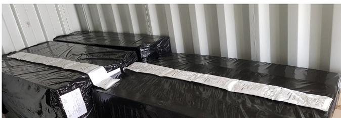
Les déshydratants conventionnels comme les sachets garnis d'argile (DESIPAK), de gel de silice (SORB-IT) ou de tamis moléculaire (TRI-SORB) ont une capacité d'absorption d'environ 20% de leur poids à 40% H.R et 20° C.
