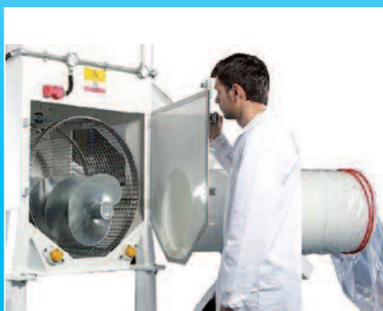
Compacteur de sacs intégré sur machine automatique d'ouverture de sacs
