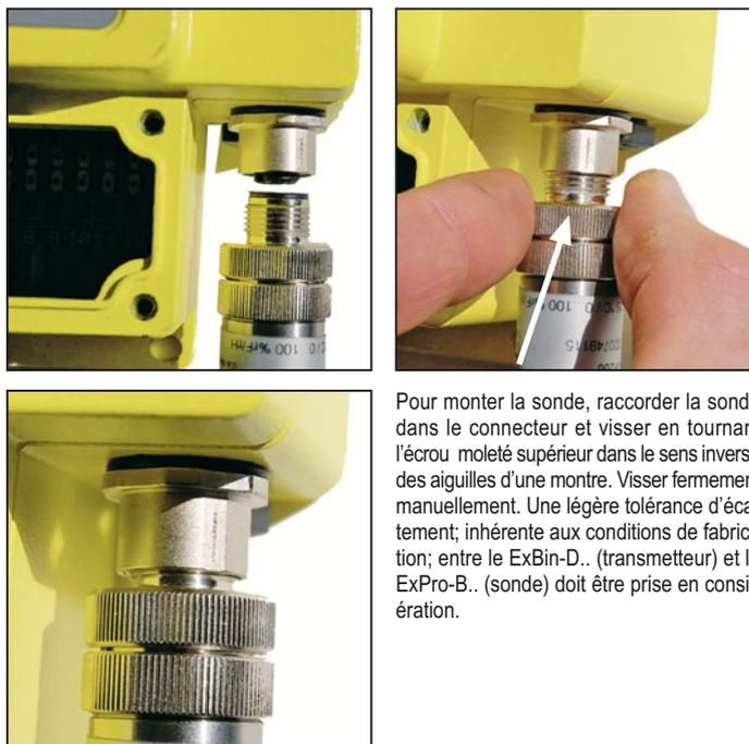
Pour monter la sonde, raccorder la sonde dans le connecteur et visser en tournant l'écrou moleté supérieur dans le sens inverse des aiguilles d'une montre. Visser fermement manuellement. Une légère tolérance d'écartement; inhérente aux conditions de fabrication; entre le ExBin-D.. (transmetteur) et le ExPro-B.. (sonde) doit être prise en considération.
