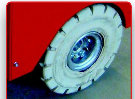
ROUES MOTRICES : 2 DIMENSIONS : 4.00 x4 PNEUS : PPS (Pneus Pleins Souples) Non tachant JANTES : Aluminium ALPAX
