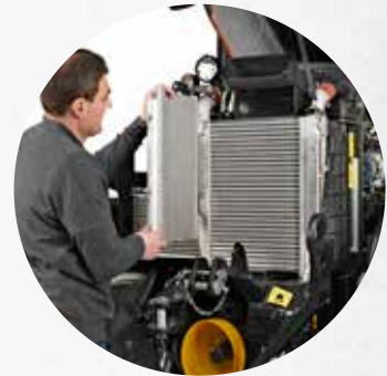
Nettoyage rapide et simple des refroidisseurs et de la climatisation.
