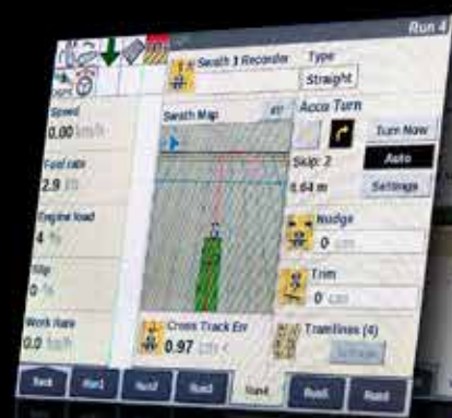
S-Turn permet de tourner automatiquement à la fin de chaque rang
