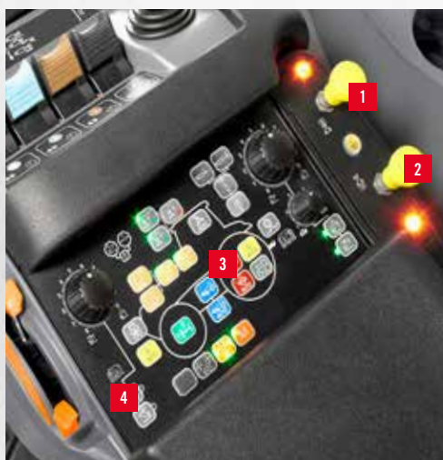
Commande de prise de force sur le Profi et le Profi CVT.
