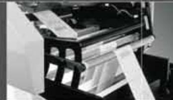
De conception simple, déverrouillez l'imprimante et tournez le module vers la gauche ou la droite pour positionner précisément le placement de l'impression sur le sac.
