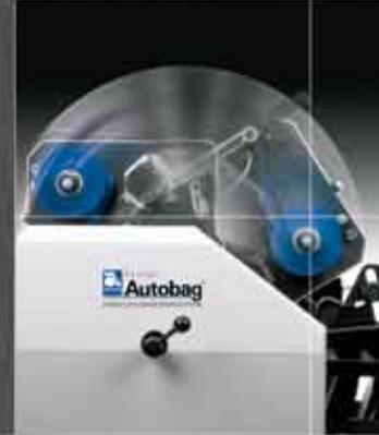
L'entraînement indépendant une exclusivité de la PI 412c, permet à l'imprimante de fonctionner en continu – indépendamment de l'ensacheuse – ce qui garantit la vitesse et l'enregistrement de l'impression.
