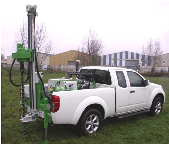
*Sondeuse géotechnique PU400*
