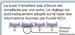
La buse n'émettant pas d'encre est remplacée par une autre. Le réglage est automatiquement adopté sur la base des informations fournies par l'unité NCU.
