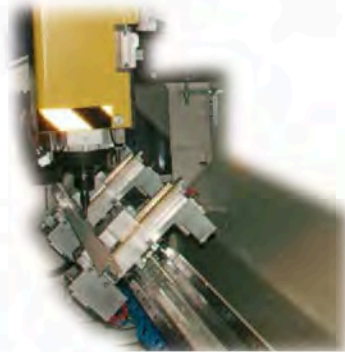
Rotation du plan de travail de la position -90° à +90°
