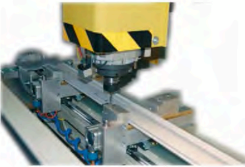
Positionnement automatique des étaux mobiles suivant l'axe X, par la CN.
