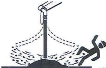
Dès lors que le volume de béton contenu dans une installation excède le volume de la trémie, il est nécessaire d'effectuer le nettoyage de la conduite par « **poussée de balles à l'air comprimé** » sous peine de faire déborder le bac de la pompe.
