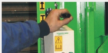
Commandes utilisateur basse tension et arrêt d'urgence rendant l'utilisation plus sûre
