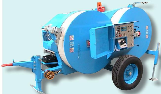
Freineuse hydraulique conçue pour l'installation d'un conducteur ou d'un câble à fibre optique. Un circuit hydraulique permet d'appliquer une force de freinage constante même à la variation de la vitesse de déroulage. Possibilité d'utiliser la machine comme treuil pour la récupération des conducteurs.
