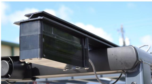
Le Hit Not est un dispositif innovant d'aide à la détection des piétons qui utilise un champ magnétique basse fréquence. Cette technologie développée il y a 10 ans aux USA a été utilisée à l'origine dans des mines. Elle permet de passer à travers le métal, le béton, la roche, etc...
