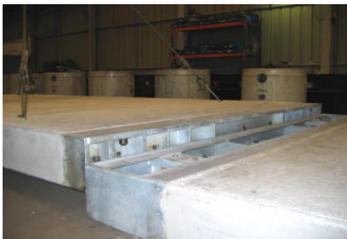
Les ponts bascules Perfect **BM** sont fabriqués et complètement assemblés et étalonnés en usine.
