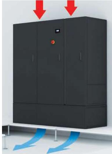
Exécution standard pour installation périmétrale à l'intérieur du data center avec hauteur du sol surélevé minimale de 550 mm. Dans ce cas, le support de hauteur fixe 550 mm, fourni de panneaux de fermeture latéraux, devra être installé sur le sol. Il est toutefois indispensable de vérifier que la hauteur du plafond permet une bonne aspiration de l'air.
