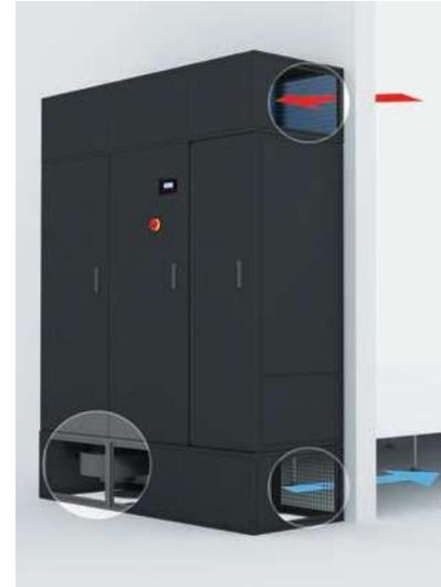
Exécution pour installation à l'extérieur du data center, sans sol surélevé et refoulement postérieur. Dans ce cas, le support de hauteur fixe 550 mm est fourni de panneaux de fermeture latéraux et de grilles de refoulement arrière. L'installation du plenum avec système d'aspiration arrière est en option, en absence d'un système de canalisation.
