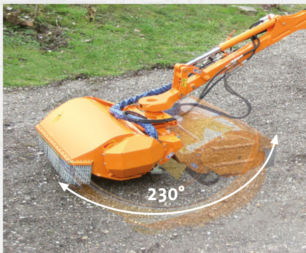
Rotation hydraulique d'outil
