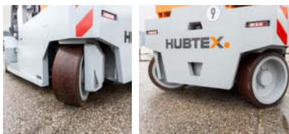
Grâce à un nouveau système de direction breveté, le rayon de giration est considérablement réduit, ce qui permet un gain de place supplémentaire de 50% par rapport à une direction standard. Dans ce cas, le point de pivotement du véhicule est idéalement situé au milieu de l'essieu moteur.
