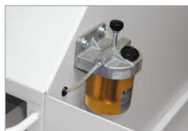
Dispositif manuel intégré de lubrification du bloc de coupe
