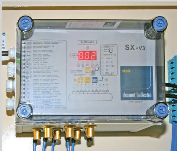
Notre séquenceur permet la commande et le contrôle de décolmatage des filtres à poches et à manches. Les électrovannes sont intégrées dans le séquenceur. L'appareil est paramétrable en fonction de l'utilisation désirée. Les coffrets séquenceurs sont équipés d'un module  $\Delta P$  qui asservit le déclenchement et l'arrêt du décolmatage. Ce dispositif permet une économie d'air et une meilleure filtration.
