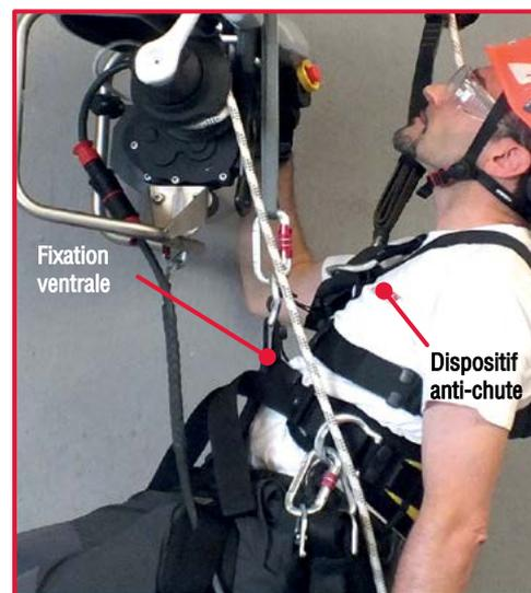
7. Fixez le mousqueton fourni avec l'équipement au point de fixation ventral du harnais
