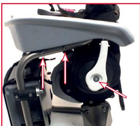
Contrôlez la vis située sur le levier de contrôle et toutes les vis fixant le siège au châssis et vérifiez qu'elles sont correctement serrées.
