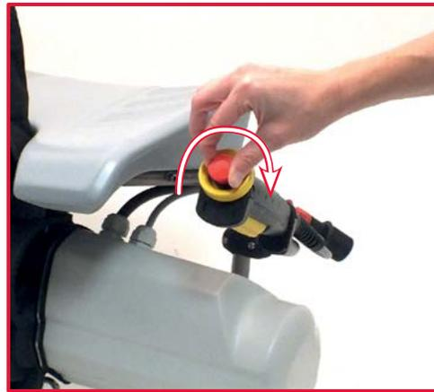
Tournez le poussoir d'arrêt d'urgence dans le sens des aiguilles d'une montre pour réarmer l'équipement.
