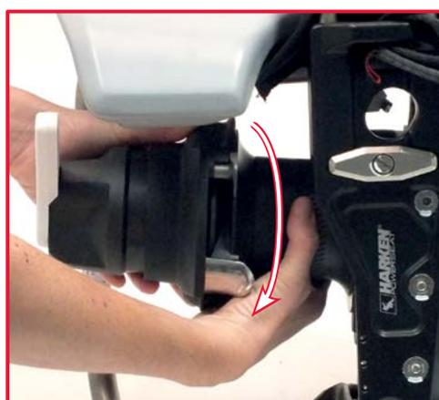
Tournez manuellement dans le sens des aiguilles d'une montre le tambour du treuil et assurez-vous qu'il ne puisse pas tourner dans le sens inverse.
