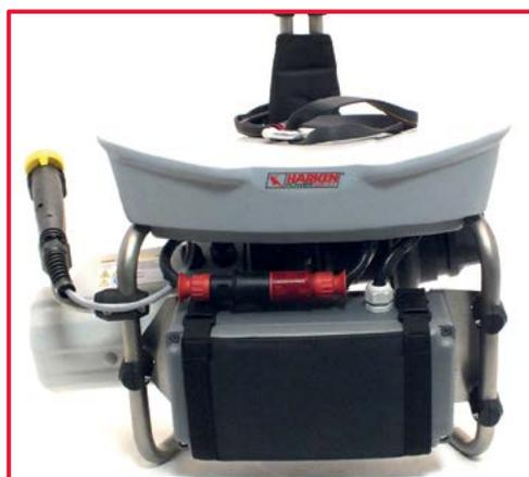
Vérifiez que les câbles et les connecteurs de la batterie/moteur sont en bon état d'entretien et branchés.
