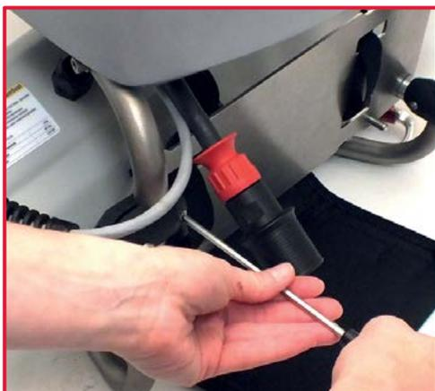
1. Après avoir débranché et retiré la batterie, dévissez la première vis d'ancrage de la commande d'accélérateur au châssis.
