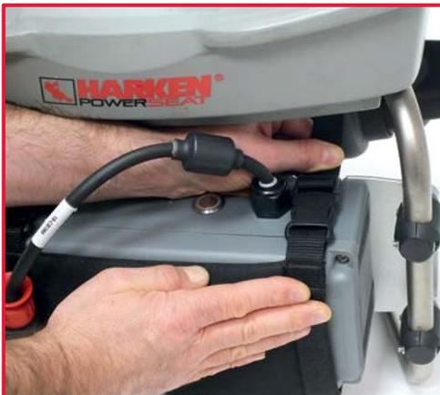
3. Vérifiez que les crochets de la couverture de protection sont placés sur la surface plate de la batterie.
