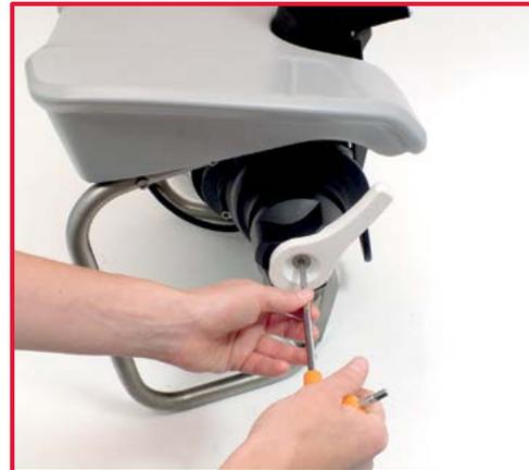
3. Serrez la vis du levier de contrôle
