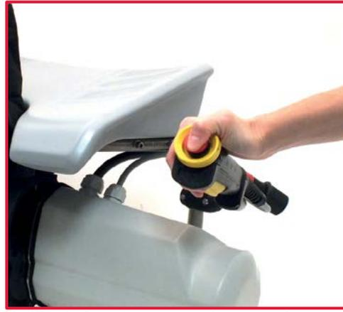
Vérifiez le fonctionnement du poussoir d'arrêt d'urgence en enfonçant le poussoir et en vérifiant l'arrêt effectif de l'équipement.
