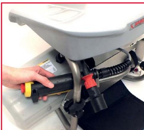
3. Retirez la commande d'accélérateur du support et passez-la à l'intérieur du châssis du PowerSeat.
