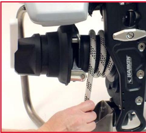
7. Enroulez la corde autour du tambour du treuil dans le sens des aiguilles d'une montre
