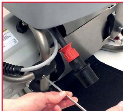
2. Dévissez la deuxième vis de la commande d'accélérateur à l'aide d'une clé Allen n° 4, en veillant à ne pas perdre l'écrou indésserrable.
