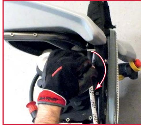
2. De l'autre main, tournez le levier de contrôle dans le sens des aiguilles d'une montre de façon à ce que la corde puisse glisser autour du tambour du treuil et permettre ainsi la descente contrôlée de l'opérateur. Pour régler la vitesse de descente, contrôlez manuellement la vitesse à laquelle la corde sort du treuil. Pour interrompre la descente, relâchez le levier de contrôle.
