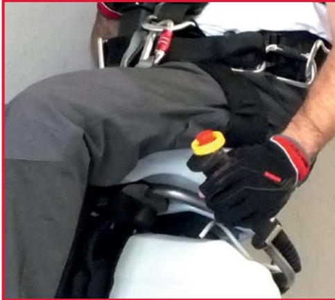
8. Adaptez la position de la commande d'accélérateur de façon à ce que l'opérateur puisse l'atteindre confortablement
