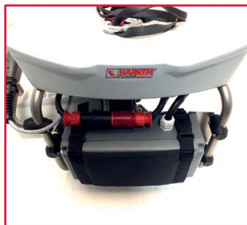
Vérifiez que les courroies de fixation de la couverture de protection sont bien fermées et correctement placées.
