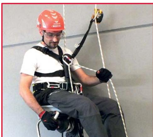
Pour faciliter la procédure de descente, vous pouvez fixer un mousqueton à l'œillet situé sur la potence de guidage et y faire passer la corde principale.
