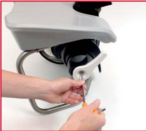
1. Desserrez la vis du levier de contrôle à l'aide d'une clé Allen n° 5
