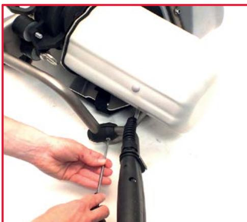
6. Remontez la commande d'accélérateur dans le support et serrez les vis.
