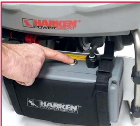
5. Allumez la batterie en utilisant l'interrupteur « 0/1 » et vérifiez son état de charge.
