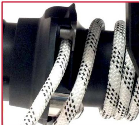
10. Insérez la corde dans le dispositif de blocage
