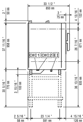
CWI1 = Raccordement eau froide      EI = Connexion électrique
