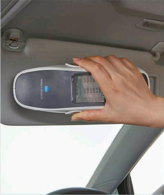
En utilisant un système d'éclairage/visualisation à 45°c:0° avec une forme circulaire dont les sources lumineuses sont placées radialement à certains intervalles, le CM-25cG fournit des données stables tout en minimisant les effets de rotation de l'instrument.
