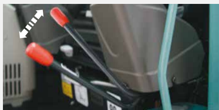
Levier de sécurité pour accéder au poste de pilotage
