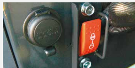
Arrêt électrique du moteur (arrêt d'urgence)
