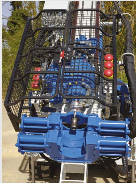
Safety cage Cage de sécurité
